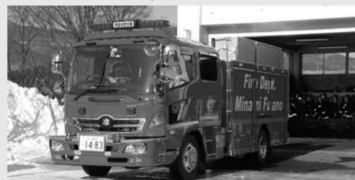
また、車体側面や上部に照明設備（LEDライト）を装備したほか、電動式油圧救助器具を搭載し、より迅速な救助活動などが行えるようになりました。
